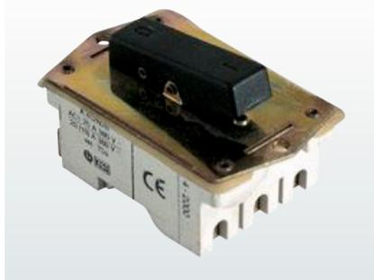
**IN.153** Interruttore tripolare stabile 20 (10) A con fori di fissaggio con interasse 58 mm. mod. LNA452N2B. Colore nero.
